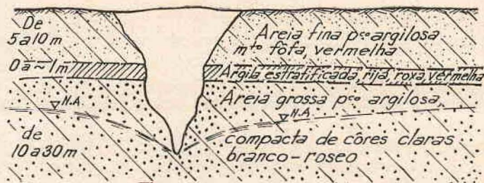
Figura n.º 1 — Secção média de uma boçoroca
