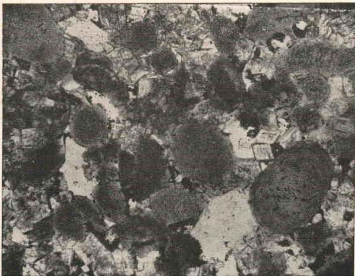
Figura 2. Lâmina de fosfato duro, de baixo teor em P_2O_5 . Os corpos escuros arredondados são coprólitos fosfatizados; além disso há calcita, dolomita, quartzo e microlina. 40x.
