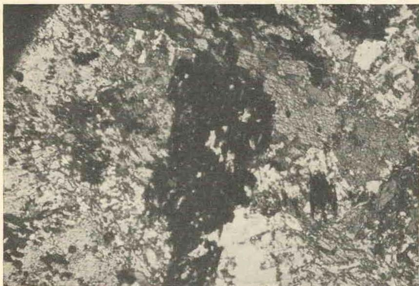
Fotomicrografia n.º 8 — Cristal de hornblenda exibindo estrutura poiquiloblástica. As inclusões são de quartzo e feldspato. Nicóis X, X 45.
