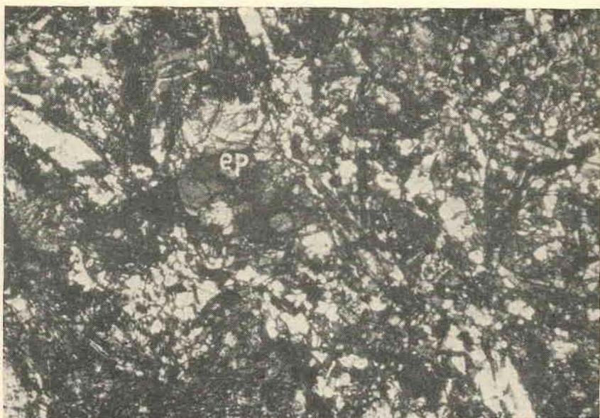
Fotomicrografia n.º 5 — Observa-se grande cristal de epídoto no interior de massa feldspática, sugerindo a sua derivação a partir desse mineral. Notar também, a forma granulada do plagioclásio. Nicóis X, X 55.
