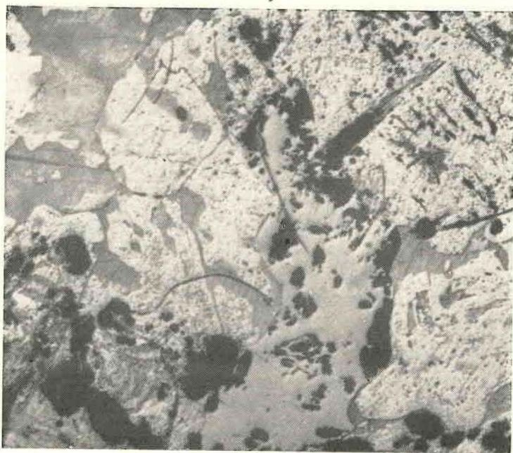
Fig. 3 — Fotomicrografia de seção polida. Jacobsita com inclusões de quartzo, rodeada por criptomelana e por outro óxido de Mn. Um dos óxidos mostra reação positiva para HCl diluído (mineral escurecido). Aumento de 123 vêzes.
