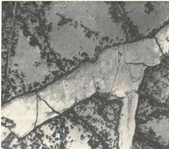
Fig. 2 — Fotomicrografia de seção polida. Jacobsita cortada por veio de criptomelana. Aumento de 50 vêzes.
