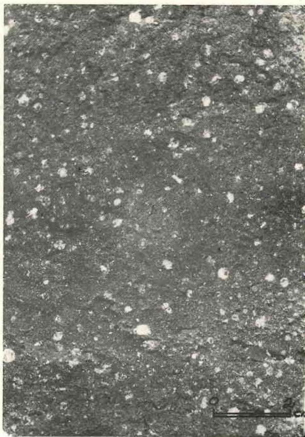
Fig. 1 — Fotografia mostrando o aspecto macroscópico da zona superior do corpo intrusivo observando-se as abundantes amígdalas de forma predominante circular.
