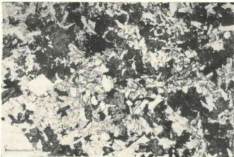
Fig. 2 — Fotografia da zona imediatamente inferior à zona amigdaloidal notando-se nitidamente a textura subofítica da rocha.
