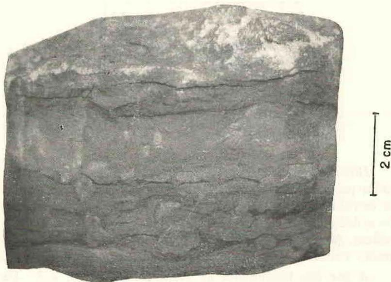
Fig. 11 — Detalhe de estruturas pseudo-nodulares e do aspecto ondulado das camadas associadas, decorrentes da ação orgânica (Ortigueira, Pr).
