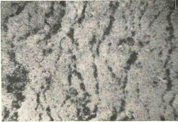
Fig. 1 — Estrutura fluidal do Quartzo pórfiro de coloração castanho avermelhado, mostrando a hematita coalescendo ao longo das linhas sinuosos. (Fotomicrografia X 30)
