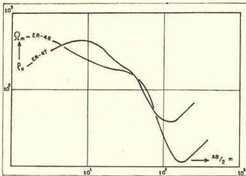
Fig. 6 — Curvas de sondagem elétrica
