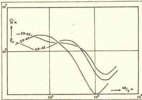
Fig. 5 — Curvas de sondagem elétrica.
